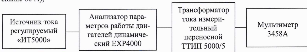
Рисунок 2 – Схема подключений для определения погрешности измерений среднеквадратического значения силы переменного тока свыше 80 А
