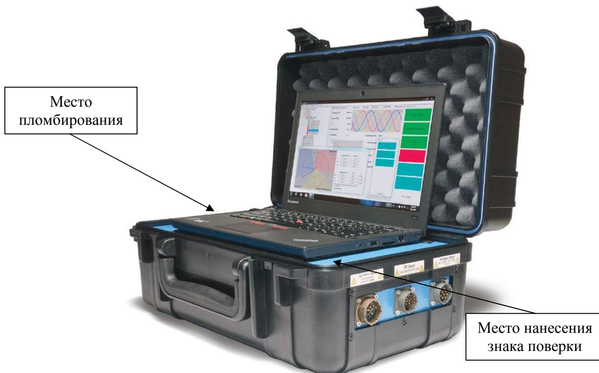
Рисунок 1 – Общий вид анализаторов с указанием места нанесения знака поверки и места пломбирования от несанкционированного доступа
