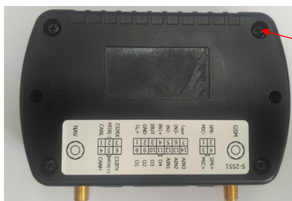
Рисунок 3 - Место пломбировки от несанкционированного доступа терминалов интеллектуальных навигационных (аппаратуры) Tetron-Profi
