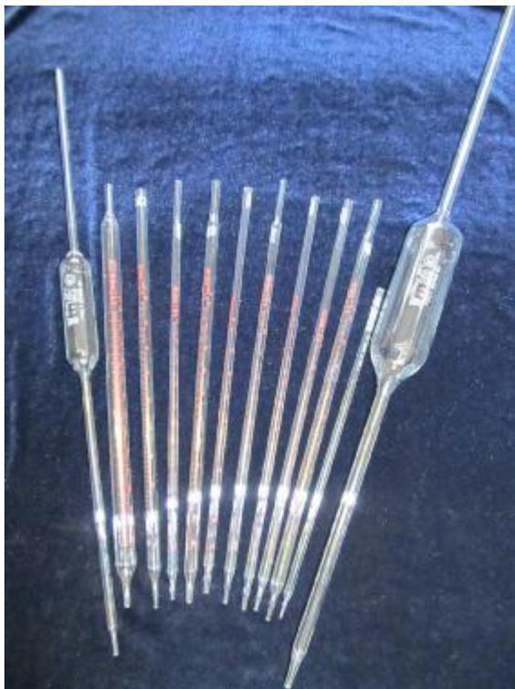
Пипетки представляют собой прямые стеклянные цилиндрические трубки с узким оттянутым концом и с нанесенными на них шкалами. Пипетки изготавливаются 1-го класса точности по ГОСТ 29227-91 следующих типов и исполнений:
