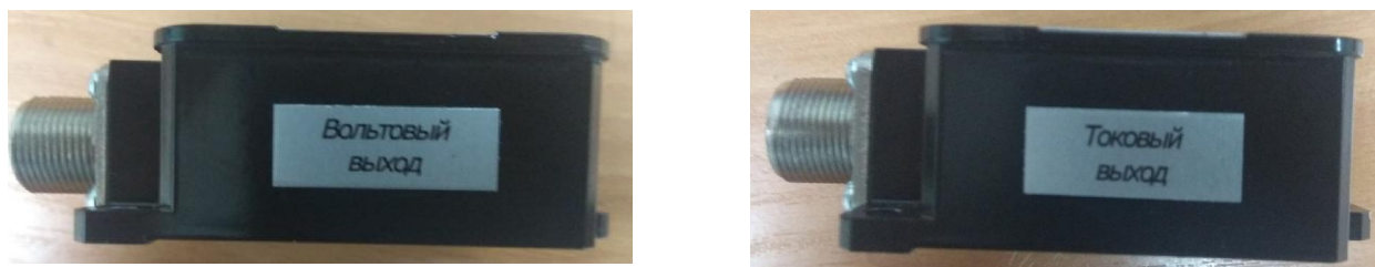
Рисунок 2 – Маркировка типа выходного сигнала преобразователей виброперемещений ИВП
