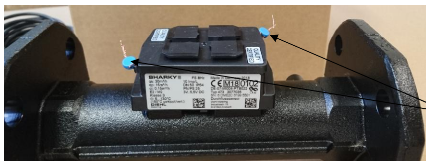
Рисунок 2 – Схема пломбировки от несанкционированного доступа
