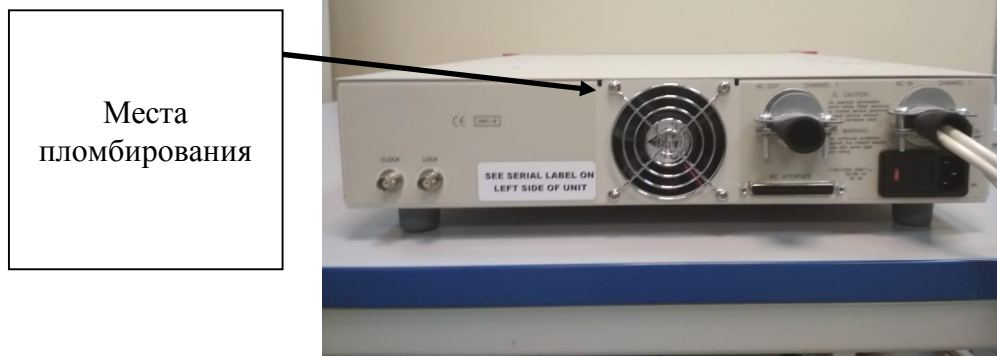
Рисунок 4 – Схема пломбировки от несанкционированного доступа систем ProfLine 2100-3
