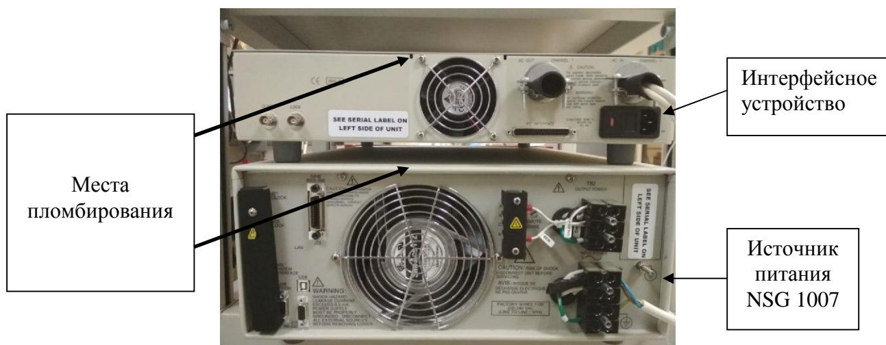
Рисунок 5 – Схема пломбировки от несанкционированного доступа систем ProfLine 2103-240, ProfLine 2105-400
