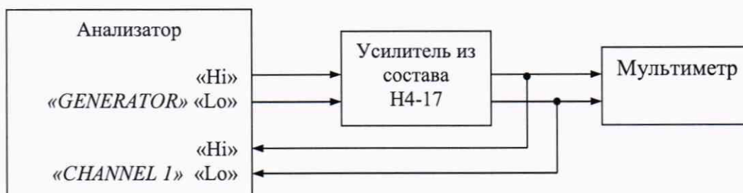
Рисунок 3 - Структурная схема соединения приборов
