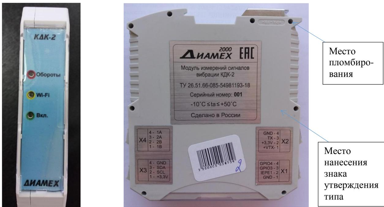
Рисунок 1 - Общий вид модулей измерений сигналов вибрации серии КДК
