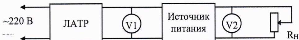
*Рис. 1. Структурная схема соединения приборов для определения основной погрешности воспроизведения выходного напряжения, нестабильности выходного напряжения от изменения напряжения питания, нестабильности выходного напряжения от изменения тока нагрузки и определения уровня пульсаций выходного напряжения.*
