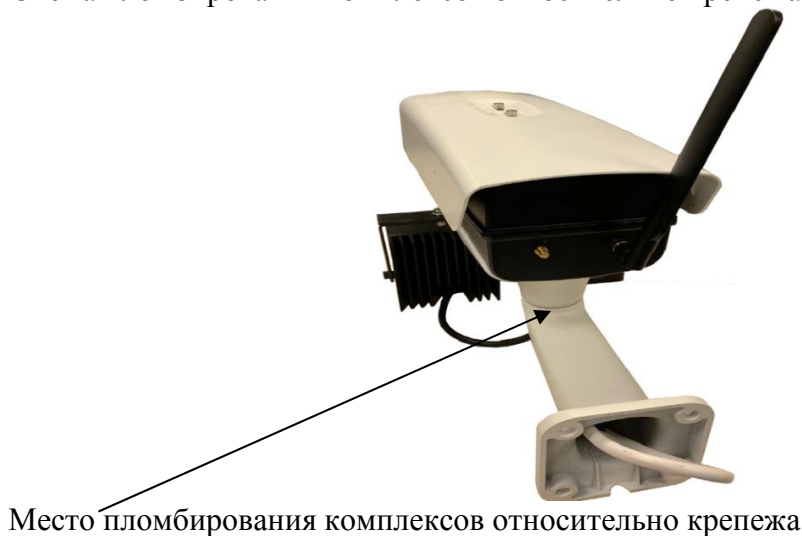
Рисунок 3 – Схема пломбирования комплексов относительно крепежа
