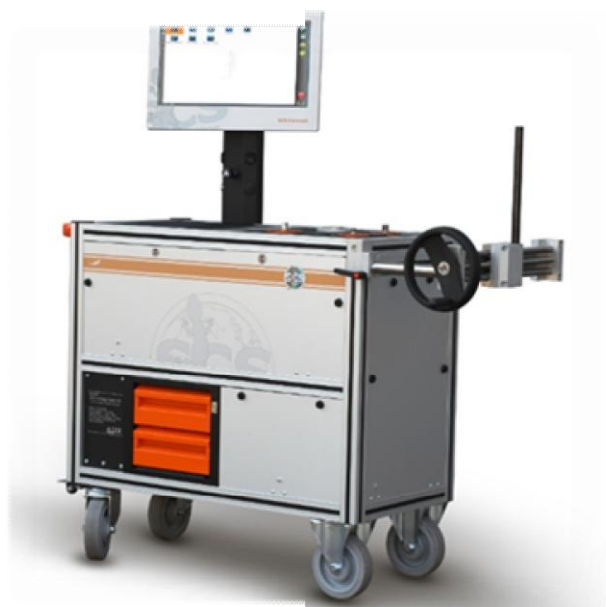
Рисунок 3 - Общий вид стендов для измерений крутящего момента силы серии FTY в сером исполнении
