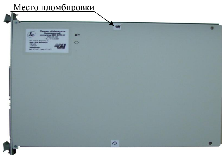
Рисунок 4 – Схема пломбировки функциональных модулей
