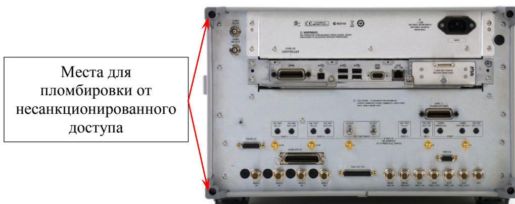
Рисунок 11 – Задняя панель ВАЦ с указанием места пломбировки от несанкционированного доступа
