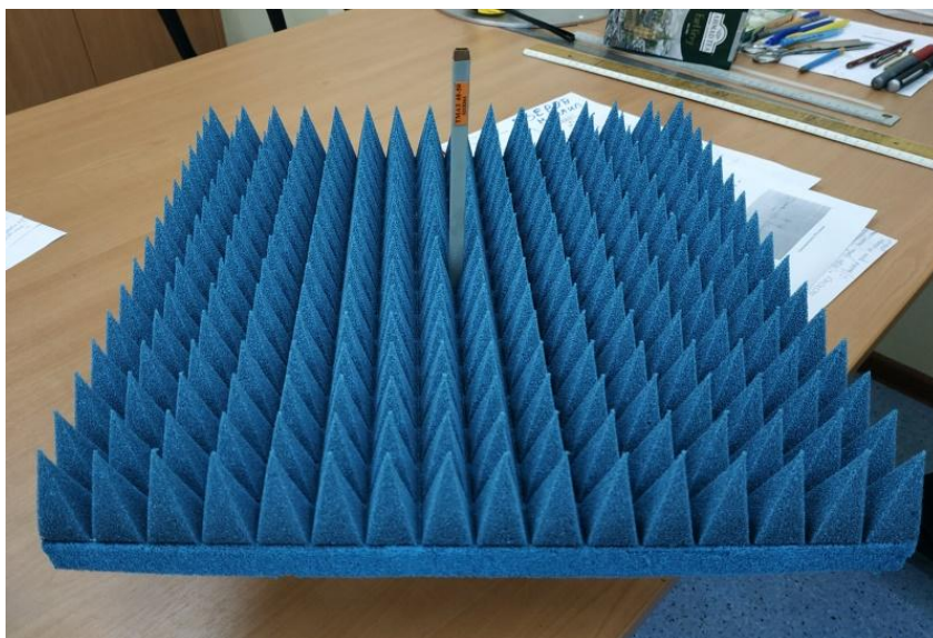
Рисунок 9 – Общий вид антенны-зонда ТМА3 40-50 диапазона частот 40 - 50 ГГц
