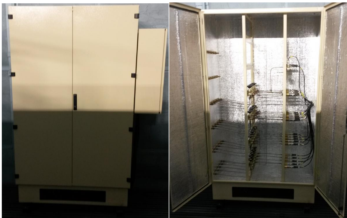
Рисунок 4 - Шкаф измерения давлений, расположенный в боксе. Расположение элементов. Вид внешний
