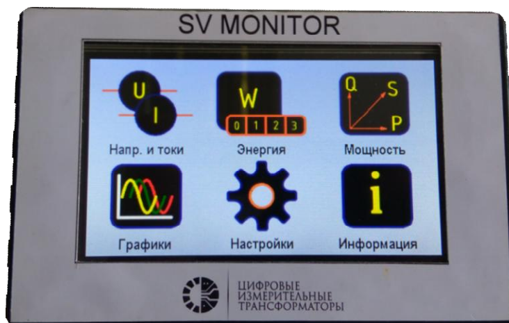
Рисунок 13 – Общий вид устройства отображения результатов измерений ЦТТ (6 (10) -220) кВ
