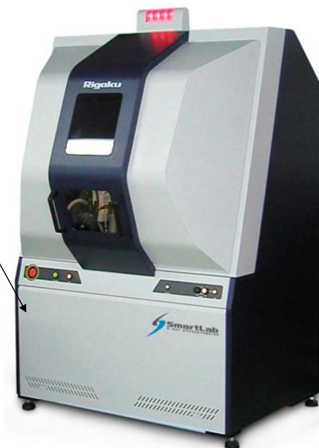
Рисунок 1 – Общий вид дифрактометра рентгеновского SmartLab
