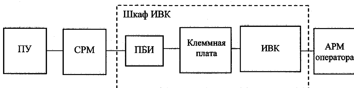
Рисунок 1. Схема подключения средств поверки при определении относительной погрешности измерений массы СРМ (ПБИ – пассивный барьер искробезопасный МТЛ, предназначенный для передачи импульсов (частотных сигналов) от СРМ из взрывоопасной зоны в безопасную зону к ИВК, влияние работы ПБИ на метрологические характеристики СРМ пренебрежимо мало и учитывается при проведении поверке СРМ. Определение дополнительных метрологических характеристик ПБИ не требуется).
