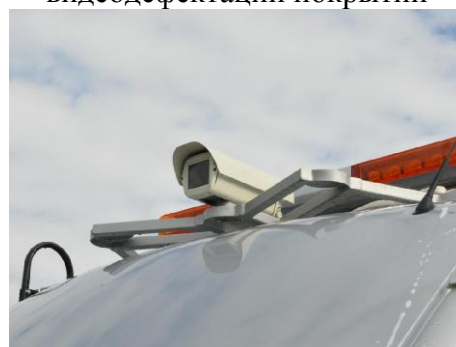
Рисунок 14 – Система видеосъемки РДТ-696.Н1 с 1-ой наружной камерой канала видеосъемки и измерений линейных размеров объектов по видеоизображению
