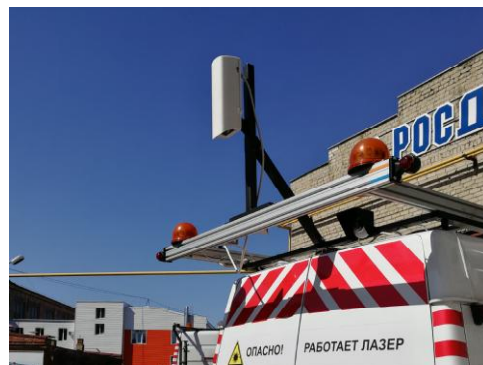
Рисунок 12 – Система видеодетекции покрытий РДТ-804 канала видеодетекции покрытий
