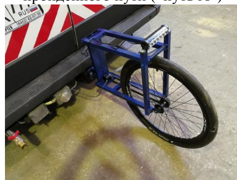
Рисунок 6 – Датчик «мерное колесо» РДТ-801 канала измерений длины пройденного пути («путь МК»)
