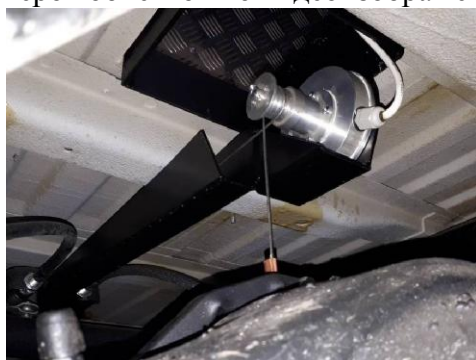
Рисунок 17 – Толкочмер РДТ-699 канала измерений амплитуды колебаний подвески транспортного средства
