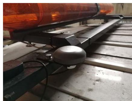
Рисунок 8 – Приёмная антенна аппаратуры геодезической спутниковой в составе спутниковой навигационной системы РДТ-802 канала измерений длины участков автомобильных дорог
