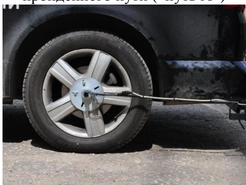
Рисунок 5 – Навесной датчик пройденного пути РДТ-691.98 канала измерений длины пройденного пути («путь Б»)
