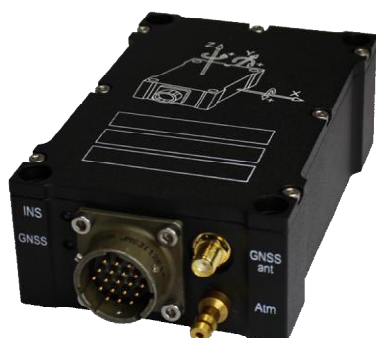
Рисунок 9 – Инерциальная навигационная система РДТ-693 (исполнение Б) канала измерений геометрических параметров
