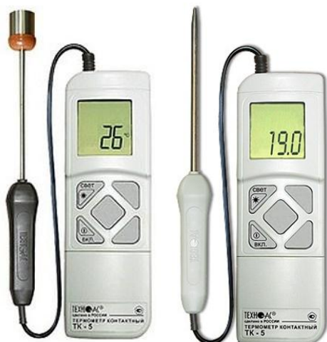
Рисунок 25 – Термометр контактный цифровой ТК-5 канала измерений температуры воздуха, слоев и поверхностей
