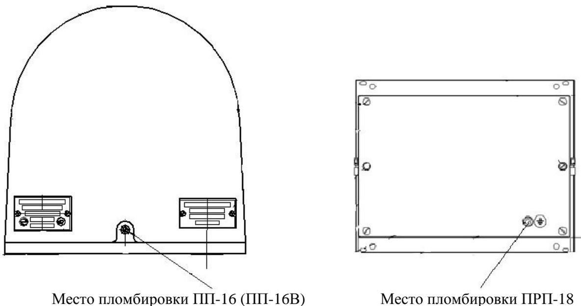
Рисунок 2 – Схема пломбировки от несанкционированного доступа газоанализатора ГТМК-18
