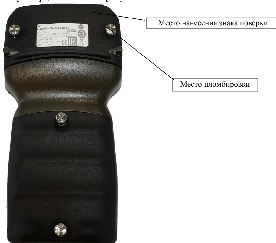
Рисунок 2 – Схема пломбировки от несанкционированного доступа
