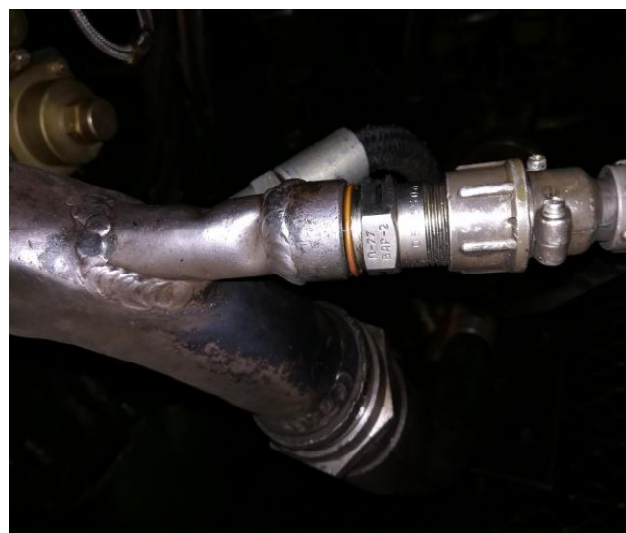
Рисунок 10 - Терморезистивный преобразователь (термосопротивление с номинальной статической характеристикой П100) П-77
