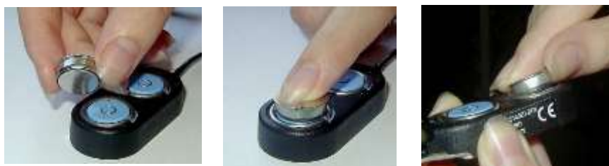
Рисунок 2.8 – Операции установки регистратора в гнездо приемного зонда
