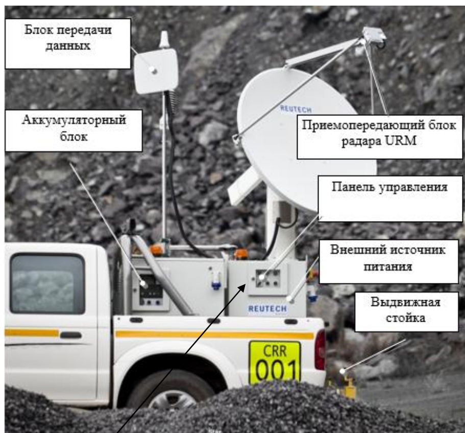
б - место нанесения наклейки со знаком утверждения типа Рисунок 3 – Общий вид системы MSR 300 rev B справа с указанием основных элементов и указанием места нанесения знака утверждения типа
