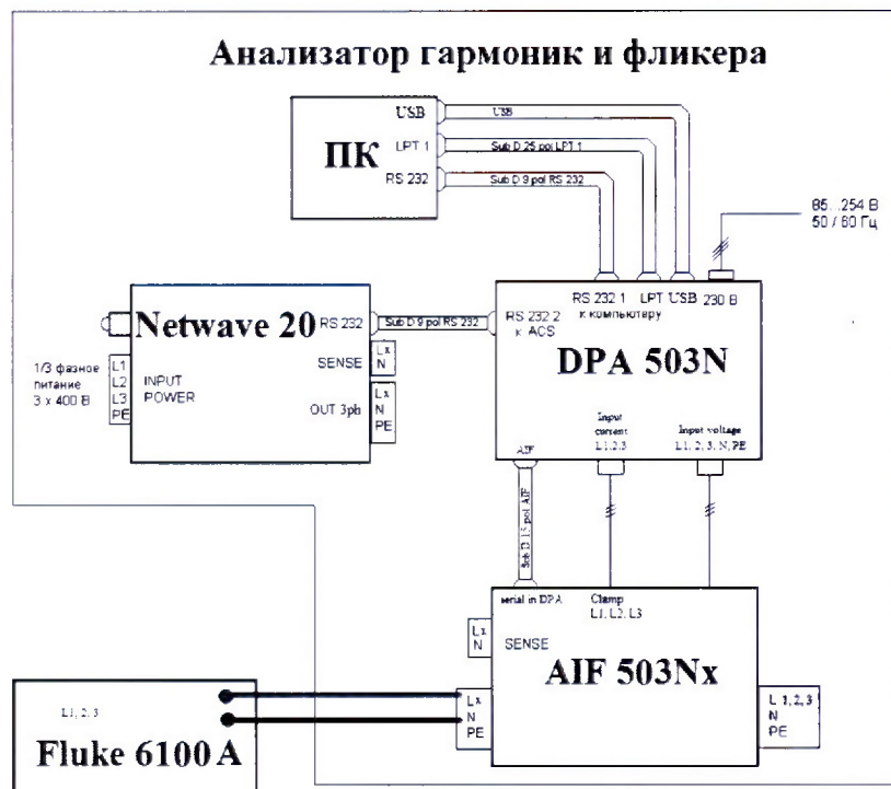
Рисунок 2 – Схема подключения к измерительному блоку для проверки режима измерений напряжения переменного тока трехфазного измерительного блока DPA 503N
