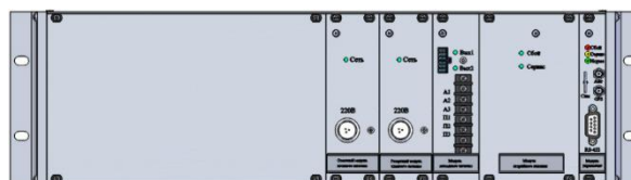
Рисунок 8 – Общий вид электронного блока резервированного блока питания повышенной надежности (вид сзади)
