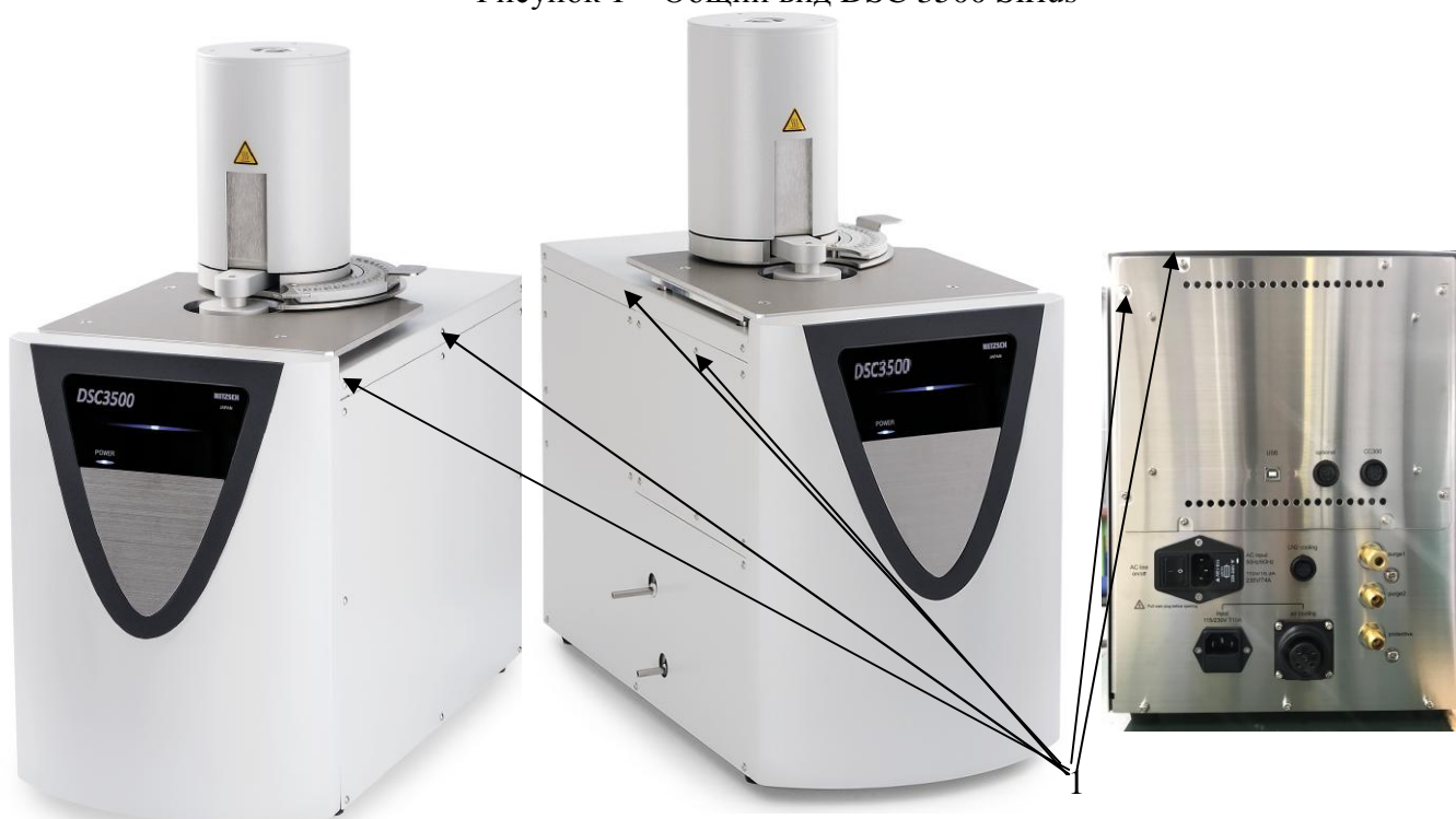
Рисунок 2 – Схема пломбировки от несанкционированного доступа calorиметра дифференциального сканирующего DSC 3500 Sirius 1 – замки на блоках управления calorиметров DSC 3500 Sirius
