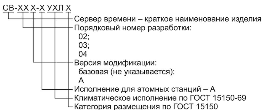
Рисунок 1 – Структура условного обозначения типа модификации устройства
