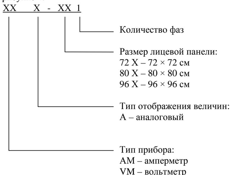
Рисунок 1 - Схема обозначения модификаций амперметров и вольтметров
