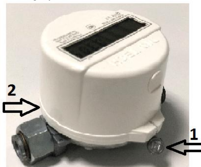
Рисунок 2 - Схема пломбировки от несанкционированного доступа (1) и обозначение места нанесения знака поверки (2) на счетчики
