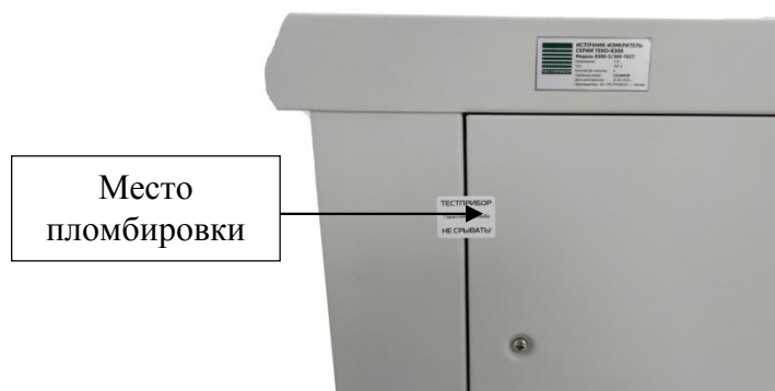
Рисунок 4 – Пломбировка приборов от несанкционированного доступа
