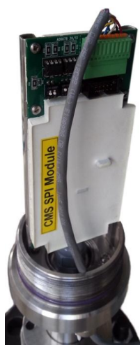
Рисунок 2 – Общий вид электронного блока без крышки, со стороны модуля SPI с подключенным кабелем питания связи и аналогового выхода к разъему J100 и переключателя, обеспечивающего защиту от внесения изменений в настройки измерителя
