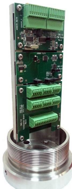
Рисунок 4 – Общий вид электронного блока в максимальной конфигурации(с опциями КомпАС-ГС и КомпАС-ГД) без крышки, со стороны платы
