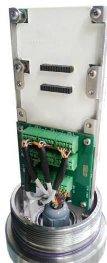
Рисунок 3 – Общий вид электронного блока без крышки, со стороны платы подсоединений с подключенными разъемами внутренних секций и датчиков температуры
