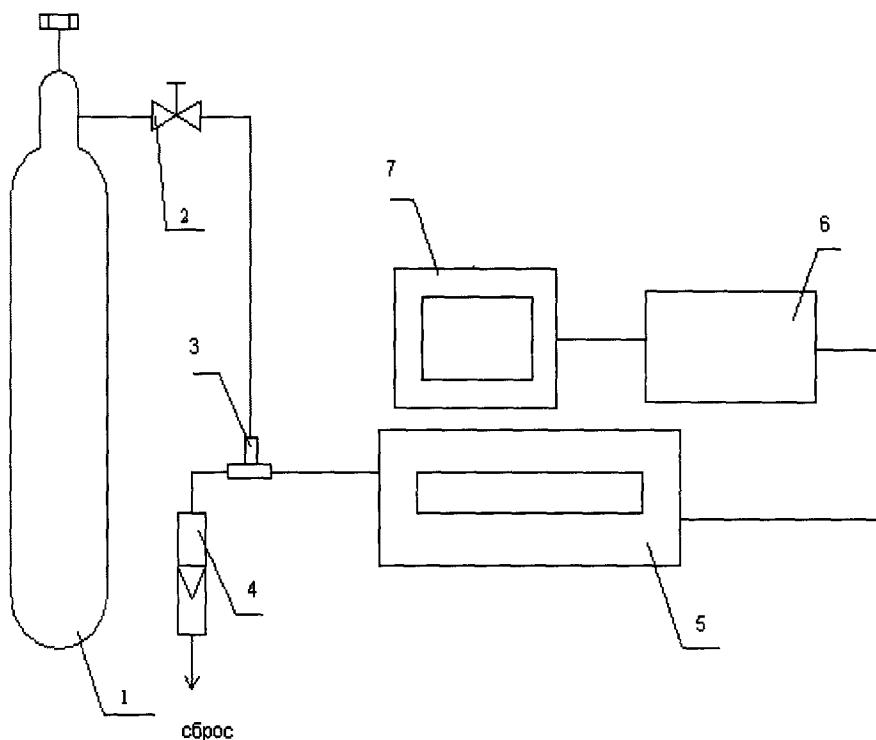
1 – баллон с ГС; 2 – вентиль точной регулировки; 3 - тройник; 4 – индикатор расхода (ротаметр);
