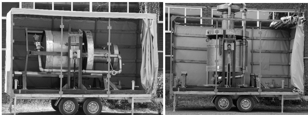
Рисунок 1 – Общий вид установок поверочных средств измерений объема и массы УПМ-2000
