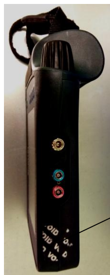
Рисунок 2 – Схема пломбировки от несанкционированного доступа
