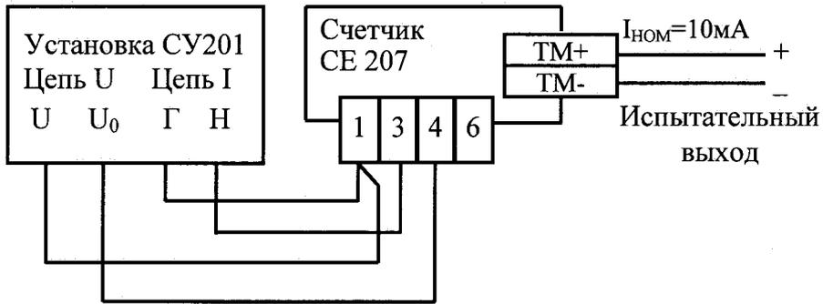
Схема подключения двухэлементного счетчика к установке СУ201 для определения погрешности при прохождении тока через цепь "нуля".
