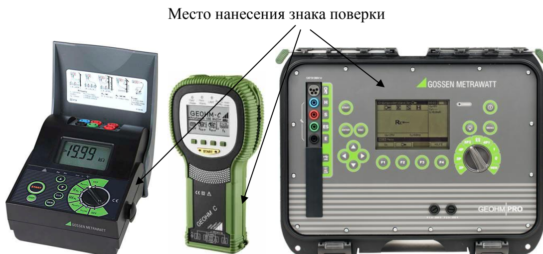
Рисунок 2 - Схема пломбирования от несанкционированного доступа, обозначение места нанесения знака поверки
