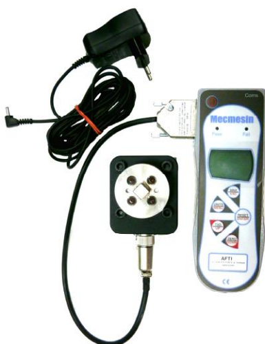
Рисунок 1 - Общий вид канала измерительного крутящего момента силы моторизированной испытательной машины Vortex
