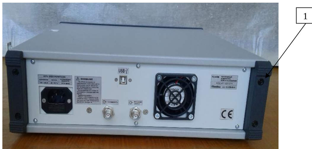
1 – место пломбирования (наклейки) от несанкционированного доступа
