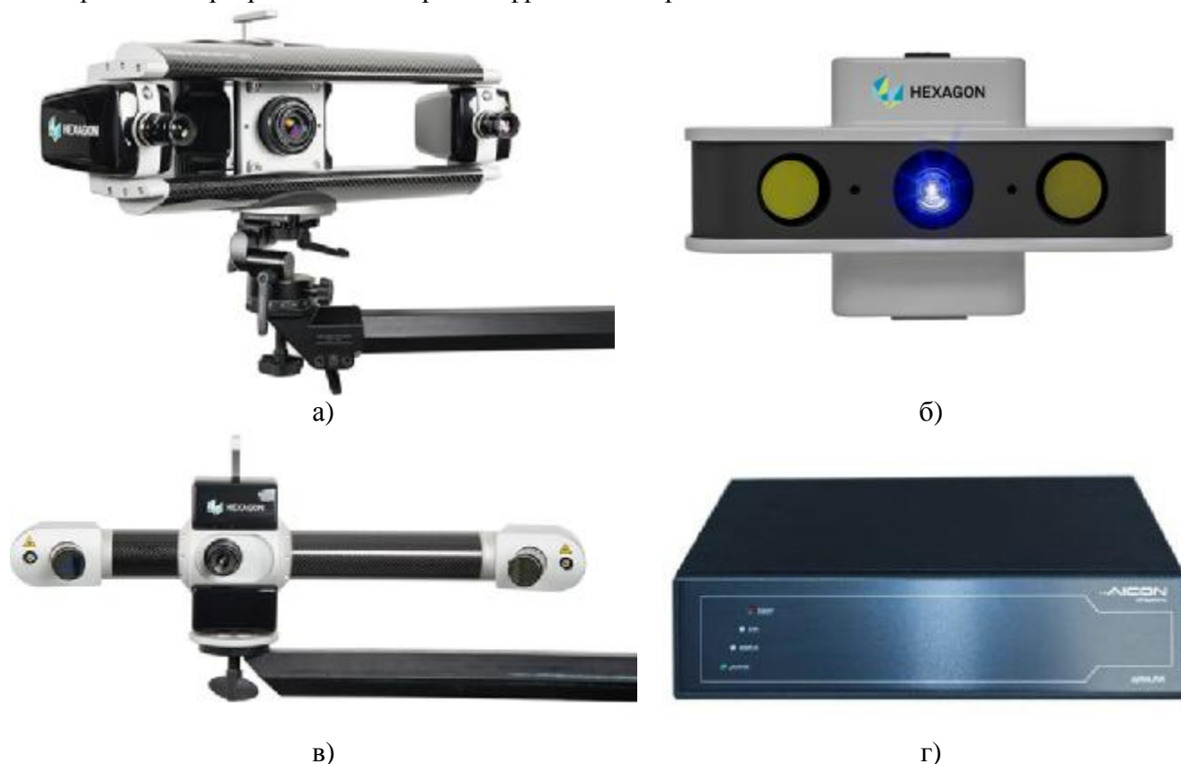
Рисунок 1 – Общий вид сканеров оптических трехмерных моделей StereoScan neo (а), PrimeScan (б), SmartScan-HE (в) и контроллера OptoLink
