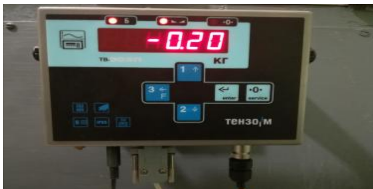
Рисунок 4 – Преобразователь весоизмерительный ТВ-003П
