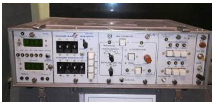
Рисунок 2 – Аппаратура измерения роторных вибраций ИВ-Д-СФ-1М.3.2-01
