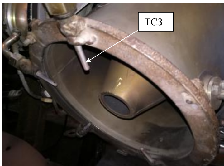
Рисунок 8 – Термоэлектрические преобразователи типа ТСЗ с номинальной статической характеристикой ТХА(К) в рабочем положении
