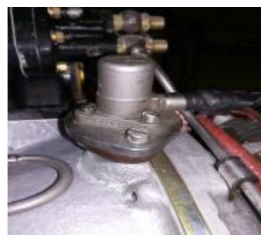
Рисунок 3 – Монтаж преобразователя вибрации МВ-43-5Б/0,35 на изделии
