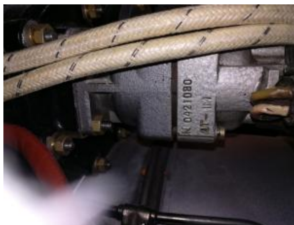
Рисунок 7 – Датчик тахометра ДТ-1М в рабочем положении (на изделии)
