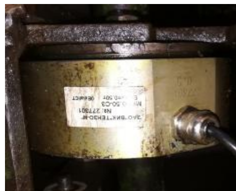
Рисунок 5 – Датчик весоизмери- тельный тензорезисторный МК2-0,5-С3 в рабочем положении
