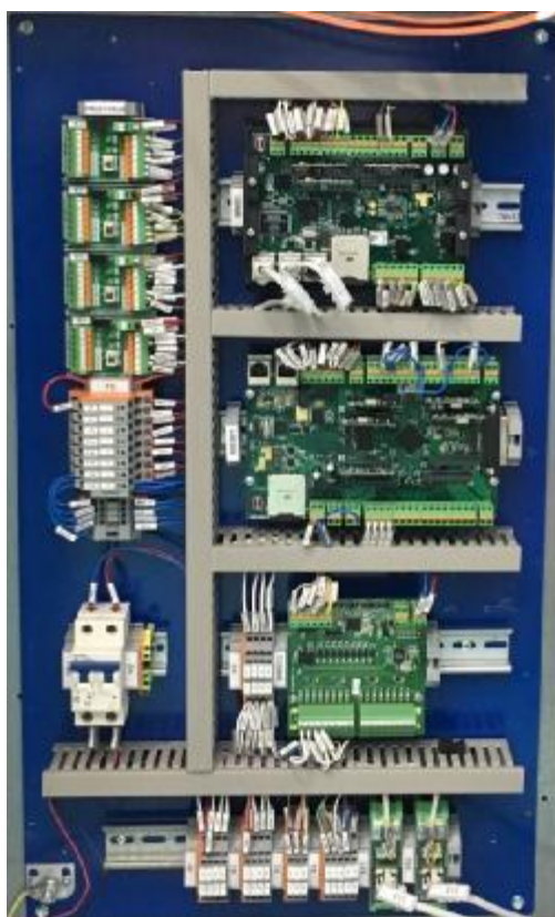
а) общий вид модулей линейных при установке на монтажную панель
