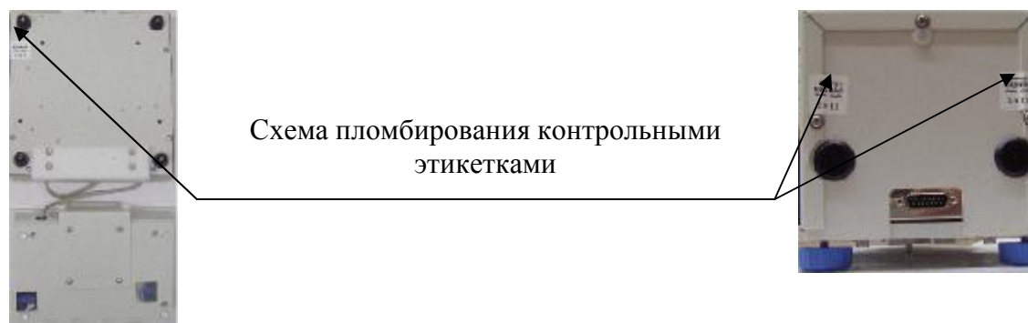
Рисунок 2 - Схема пломбирования от несанкционированного доступа
