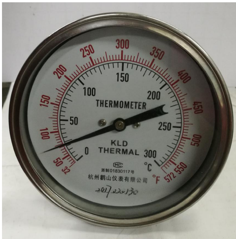
Рисунок 1 - Общий вид термометров биметаллических 01830117
