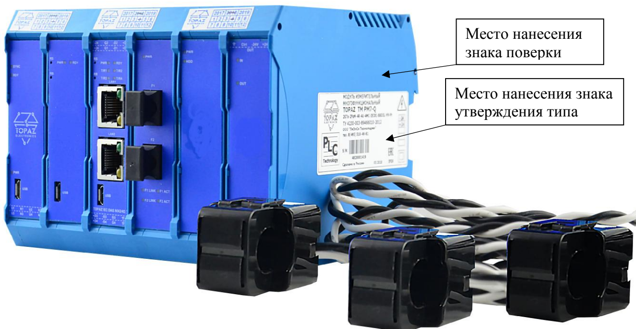
Рисунок 2 – Общий вид средства измерений с выносными трансформаторами тока, места нанесения знака утверждения типа и знака поверки
