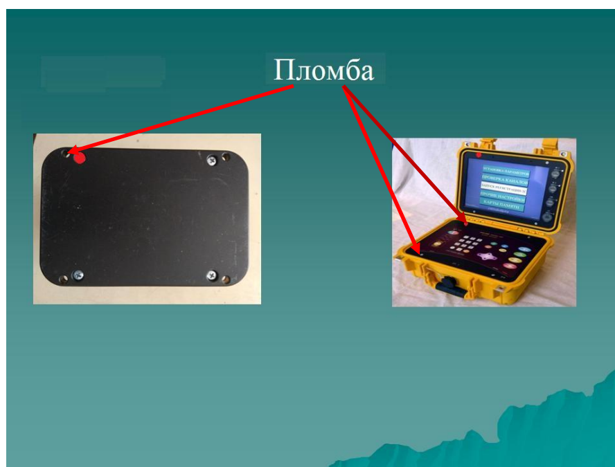
Рисунок 2 – Схема пломбировки от несанкционированного доступа
