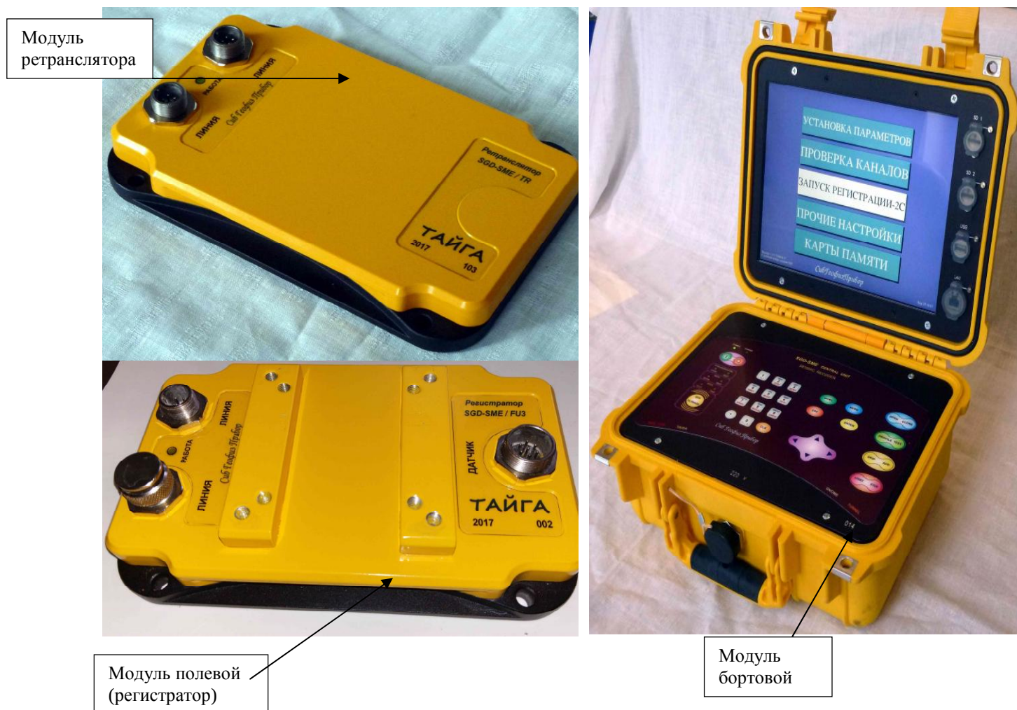
Рисунок 1 – Общий вид станции телеметрической сейсмического мониторинга SGD-SME30
