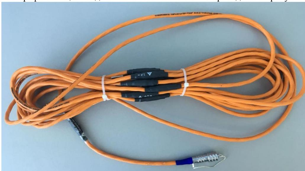
Рисунок 1 – Общий вид измерителя температуры ИТМ
