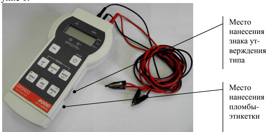
Рисунок 1 – Внешний вид омметра цифрового CROPICO DO4000
