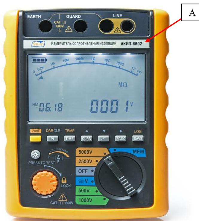
Рисунок 1 – Общий вид измерителей и место знака утверждения типа (А)
