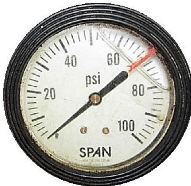
Рисунок 1 – Внешний вид манометров деформационных показывающих LFC-210-100-G
